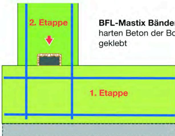
**BFL-Mastix Bänder Typ R** auf harten Beton der Bodenplatte geklebt
