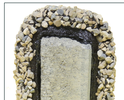
Band mit schwarzem Mastix MS-Polymer geklebt
