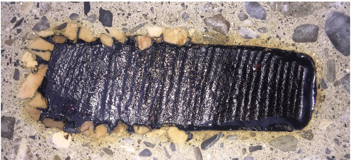
**Les gravillons ou granulats sélectionnés pour recouvrir entièrement ou partiellement le noyau déformable des bandes BFL-Mastix présentent d'excellentes propriétés d'accrochage physique avec la pâte de ciment. Cet accrochage physique va encore s'améliorer au cours du temps par un accrochage chimique.**
