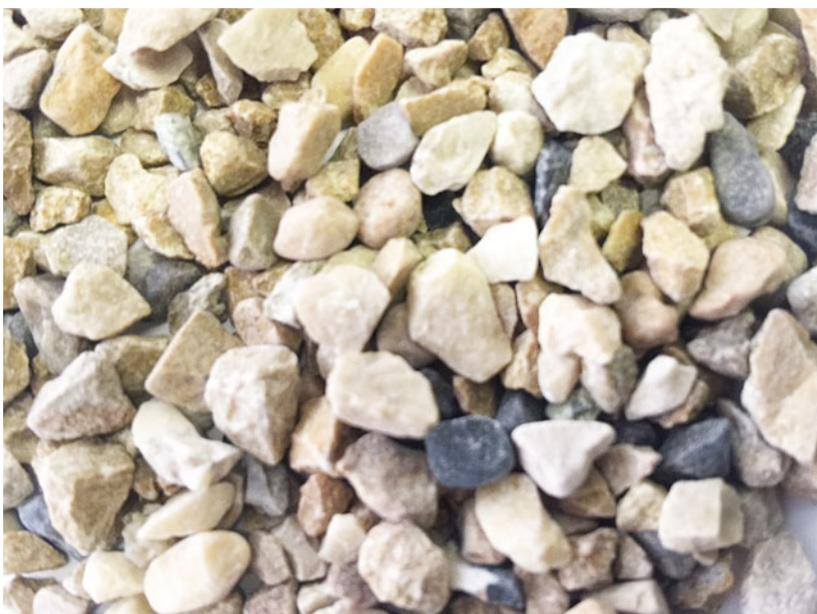
**La bonne cubicité de la forme des granulats permet un excellent enrobage même avec un minimum de pâte de ciment, ce qui évite le recours à des bétons enrichis en pâte de ciment. Avec tous les types de béton on obtiendra une étanchéité parfaite avec les gravillons sélectionnés qui recouvrent les bandes BFL-Mastix.**
