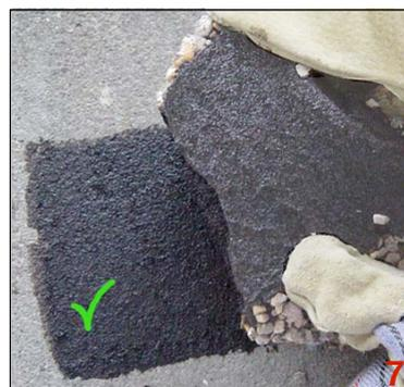
Pour tester l'adhérence des bandes au béton, on peut soulever une bande immédiatement après son application. Si la matière reste collée sur le béton (7) le collage est bon. Si la matière reste partiellement collée au béton (8), le collage n'est pas bon, le béton n'était pas assez chaud.
