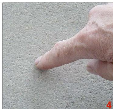
Si la trace du doigt mouillé sèche immédiatement, la température du support est correcte.
