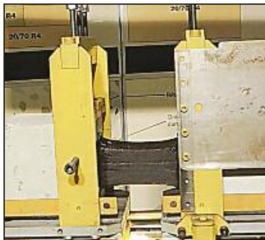
Fin de l'essai de traction
