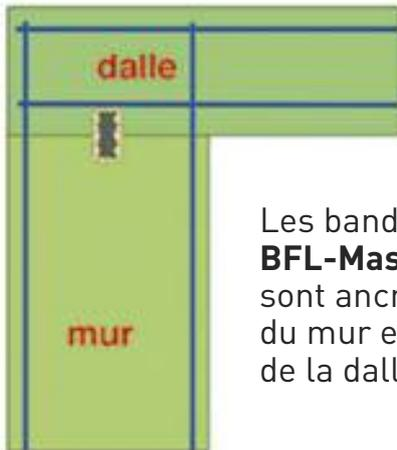
Les bandes **BFL-Mastix type R4** sont ancrées dans le béton du mur et dans celui de la dalle.
