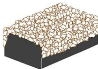
Wasserdichtungsbänder für Schwind- und Kontrollfugen. Eine Seite des Bandes ist zum Verkleben auf hartem Beton, auf Metall oder auf PVC vorgesehen. Eine verformbare Reserve zur Aufnahme von Schwind- oder Setzbewegungen. Halbhoher seitlicher Splittbelag zur Haftung mit frischem Beton.
