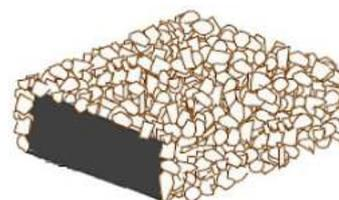
Wasserdichtungsbänder für Anschluss- und Arbeitsfugen. Drei Seiten der Bänder sind für eine perfekte Haftung im frischen Beton mit Feinsplitt beschichtet. Eine splittfreie Seite ist für das Verkleben auf harten Beton, auf Metall oder PVC.
