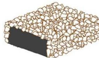
Wasserdichtungsbänder für Anschluss- und Arbeitsfugen. Drei Seiten der Bänder sind für eine perfekte Haftung im frischen Beton mit Feinsplitt beschichtet. Eine splittfreie Seite ist für das Verkleben auf harten Beton, auf Metall oder PVC.
