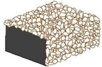
Wasserdichtungsbänder für Anschluss- und Arbeitsfugen. Zwei Seiten der Bänder sind für eine perfekte Haftung im frischen Beton mit Feinsplitt beschichtet. Zwei Seiten zum Kleben auf harten Beton, auf Metall oder PVC.
