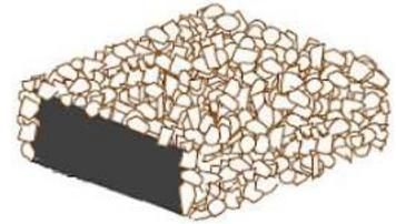
Wasserdichtungsbänder für Abschlussfugen. Drei Seiten der Bänder sind für eine perfekte Haftung im frischen Beton mit Feinsplitt beschichtet. Eine splittfreie Seite ist für das Verkleben auf harten Beton, auf Metall oder PVC.
