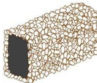
Wasserdichtungsbänder für Anschluss- und Arbeitsfugen. Vier Seiten der Bänder sind für eine perfekte Haftung im frischen Beton mit Feinsplitt beschichtet.
