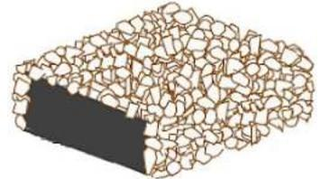
Wasserdichtungsbänder für Anschluss- und Arbeitsfugen. Drei Seiten der Bänder sind für eine perfekte Haftung im frischen Beton mit Feinsplitt beschichtet. Eine splittfreie Seite ist für das Verkleben auf harten Beton, auf Metall oder PVC.
