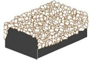
Wasserdichtungsbänder für Schwind- und Kontrollfugen. Eine Seite des Bandes ist zum Verkleben auf hartem Beton, auf Metall oder auf PVC vorgesehen. Eine verformbare Reserve zur Aufnahme von Schwind- oder Setzbewegungen. Halbhoher seitlicher Splittbelag zur Haftung mit frischem Beton.
