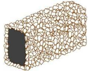
Wasserdichtungsbänder für Anschluss- und Arbeitsfugen. Vier Seiten der Bänder sind für eine perfekte Haftung im frischen Beton mit Feinsplitt beschichtet.
