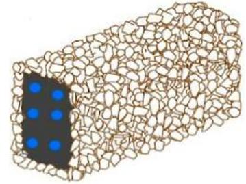
Wasserdichtungsbänder für Anschluss- und Arbeitsfugen. Vier Seiten der Bänder sind für eine perfekte Haftung im frischen Beton mit Feinsplitt beschichtet. Verstärkte Bänder.
