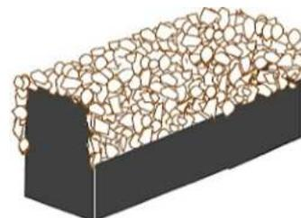
Wasserdichtungsbänder für Schwind- und Kontrollfugen. Eine Bandseite zum Einkleben in einen Nut zur Haftung auf hartem Beton, auf Metall oder PVC. Eine verformbare Reserve zur Aufnahme von Schwind- oder Kontrollfugen. Halbhoher seitlicher Splittbelag zur Haftung mit frischem Beton.
