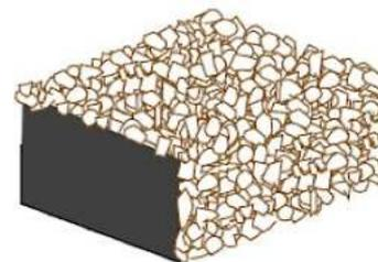
Wasserdichtungsbänder für Anschluss- und Arbeitsfugen. Zwei Seiten der Bänder sind für eine perfekte Haftung im frischen Beton mit Feinsplitt beschichtet. Zwei Seiten zum Kleben auf harten Beton, auf Metall oder PVC.
