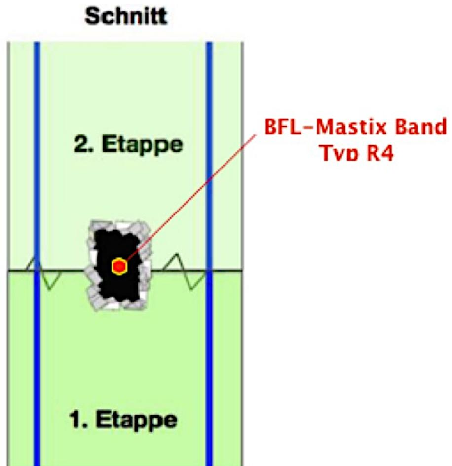
**BFL-Mastix Fugenbänder sind Produkte, die dauerhaft das Wasserzirkulieren längs der Anschlussfugen von Betonbauten verhindern.**
